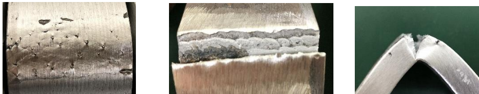
図2(1)-1 ブローホール (左)、溶け込み不良による割れ (中、右)
