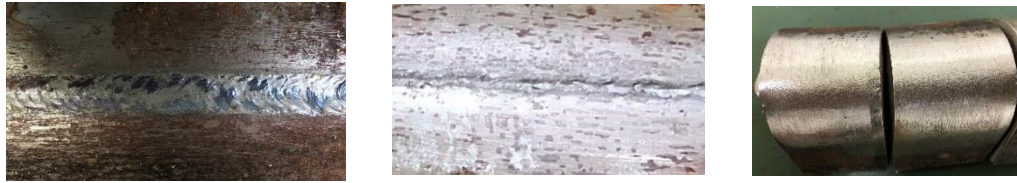
図2(2)-2 SN-2 F表 (左)、裏 (中)、曲げ試験
