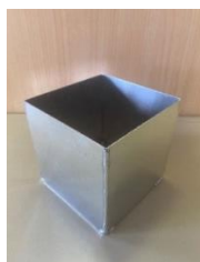
図1 アルミ材 t=1 mm の箱
